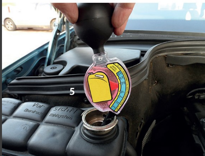
1 – króciec wlewu zbiorniczka 2 – zbiorniczek wyrównawczy 3 – glikomat 4, 5 – zasysanie cieczy 6 – odczyt wyniku pomiaru
